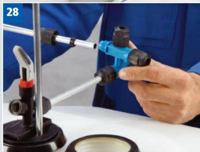
28) Montage Entnahmekreuz (90° versetzt bei L-Aufstellung).
