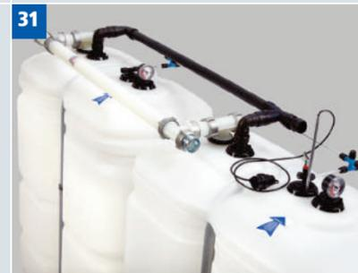
35) Sonde in die Entnahmeerweiterungseinheit einführen. Einstellmaß der weiteren Kaltleitersonde(n) einstellen (Einstellwerte gemäß separater Montageanleitung Überfüllsicherung bitte beachten!). Anschließend mit der seitlichen Sicherungsschraube fixieren.
