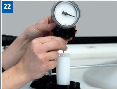
22) Schwimmer vorsichtig in Tank ablassen und Inhaltsanzeiger in Tankadapter einschrauben.
