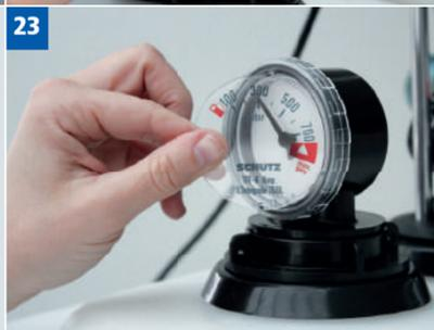
23) Ausgewählte Skala ausrichten und von außen leicht andrücken.
