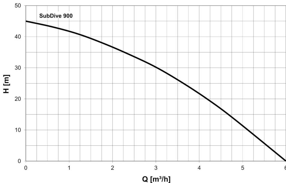
Diese Übersicht basiert auf einer kinematischen Viskosität von  $1 \text{ mm}^2/\text{s}$  und einer Dichte von  $1.000 \text{ kg/m}^3$ .
