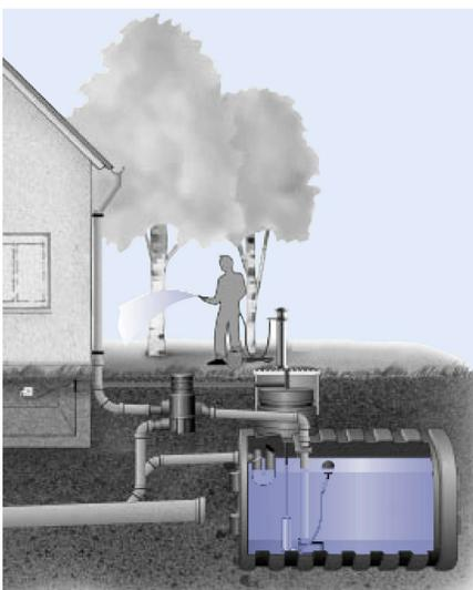
Dieses Schema zeigt die SubDive in Kombination mit einer Zapfsäule zur Gartenbewässerung. In diesem Aufbau braucht keine Leitung bis ins Haus verlegt werden, nur die Stromleitung muss, wenn keine Steckdose im Garten ist, bis ins Haus verlegt werden.
