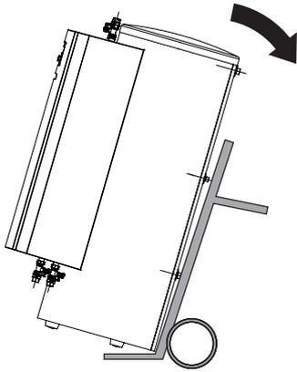
2. Die Hydraulikstation mit Spanngurt auf Sackkarre sichern.
