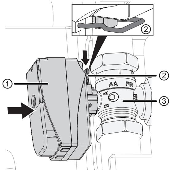
9. Sicherstellen, dass der Bügelstift korrekt eingearastet ist:
