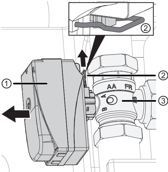
3. Spindel am 3-Wege-Umschaltventil drehen, so dass die abgerundete Seite der Spindel in Richtung Markierung A der Anschlüsse am 3-Wege-Umschaltventil zeigt.
