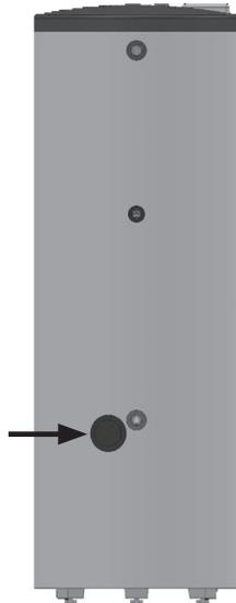
3. Schaltkasten im Gerät öffnen. Hierzu die oberen beiden Schrauben des Abdeckblechs nur anlösen. Die restlichen Schrauben entfernen. Abdeckblech aushängen.
