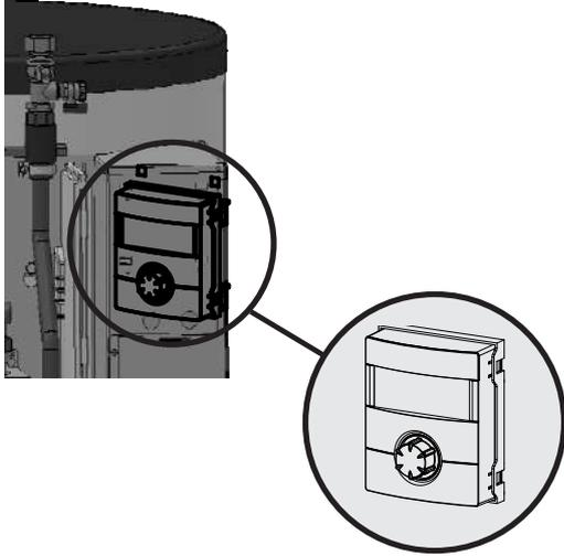
3. Das eingehängte Bedienteil nach unten drücken, bis es einrastet.
