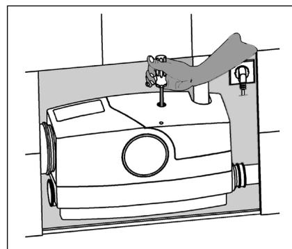
2. Se la pompa funziona con difficoltà o è bloccata, è possibile rimetterla in funzione con un cacciavite, senza smontarla. A tal fine rimuovere il tappo del foro nella calotta di copertura. Inserire un cacciavite lungo (Torx 30 o incavo H5) attraverso il foro nella calotta di copertura. Tramite una leggera rotazione rilevare la posizione nell'albero motore e rimuovere il blocco tramite una rotazione più energica dell'albero in entrambe le direzioni.
