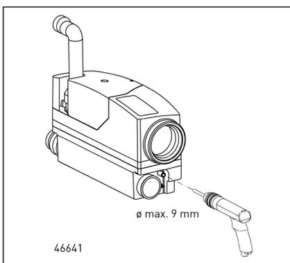
Für eine einfache Notentsorgung des angestauten Abwassers im Behälter kann ein Stück Gartenschlauch am Behälter unten rechts montiert werden. Dazu muss der Stutzen Ø 13 unten am Behälter mit einem Spiralbohrer (max. Ø 9) aufgebohrt werden. Den Schlauch aufschieben und mit einer Schlauchschelle sichern (Anziehdrehmoment 1,5 Nm). Darauf achten, dass die Ablauföffnung des Schlauches sicher verschlossen ist.
