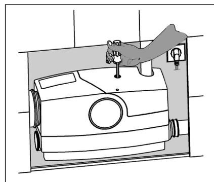
2. 如果泵机滞缓或阻塞，可使用螺丝刀使其重新恢复运行，而无需进一步拆卸。为此应取下盖子中孔上的塞子。将一把长螺丝刀（Torx 30或平头螺丝H5）插入盖子孔内。缓缓转动螺丝刀，直到它与电机轴中的槽口啮合，然后用力在两个方向上对轴进行转动，清除阻塞。
