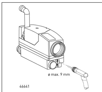
Voor een eenvoudige noodafvoer van opgehoopt afvalwater in de tank kan onderaan rechts een stuk tuinslang op het
