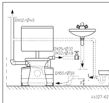
**ATTENZIONE!** Un tubo di collegamento tra WCFIX e la toilette causa anomalie di funzionamento. Questo stato d'installazione non è conforme alle disposizioni del Istituto tedesco dei metodi costruttivi (Deutsches Institut für Bautechnik).
