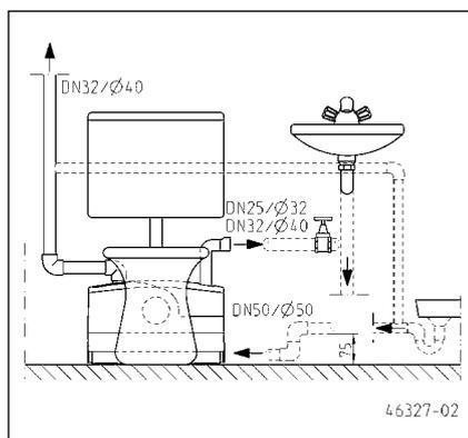
注意！如果在WCFIX与座便器之间安接连接管，会引发故障问题。这种安装方式不符合德国建筑技术研究院（德国建筑产品和建筑类型的管理机构）的规定要求
