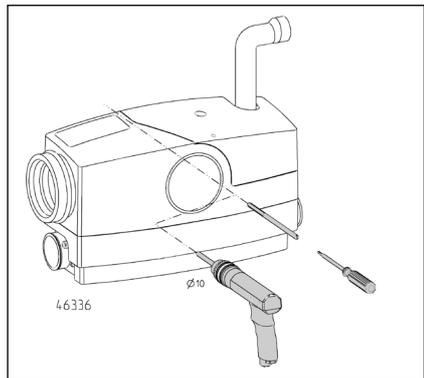
对于本污水提升装置，必须作好防浮力保护。安装地点切不可发生灌水情况。
