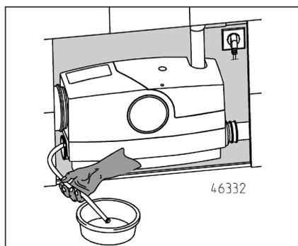
Si un tuyau a été monté sur le collecteur, vous pouvez procéder en toute facilité à une élimination d'urgence des eaux usées accumulées. Pour ce faire, l'eau résiduelle est évacuée dans un récipient plat via le tuyau. Le tuyau est ensuite de nouveau obturé à l'aide d'un bouchon approprié.
