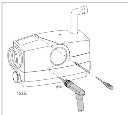
Les postes de relevage pour matières fécales doivent être protégés contre les poussées verticales. L'emplacement du montage ne doit pas être submergé.
