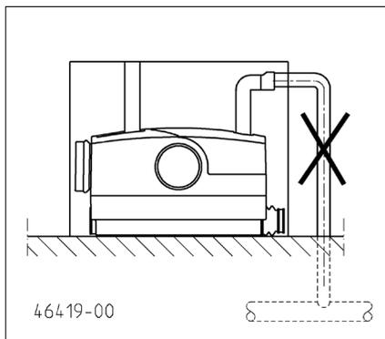
Per uno smaltimento d'emergenza semplice delle acque di scarico accumulate nel serbatoio è possibile montare un pezzo di tubo da giardino nel serbatoio in basso a destra. A tal fine la bocca di Ø 13 sotto il serbatoio deve essere forata con un trapano a spirale (max. Ø 9). Inserire il tubo e fissare con una rondella per flessibili (coppia di serraggio 1,5 Nm). Verificare che l'apertura di scarico del tubo è chiuso in sicurezza.
