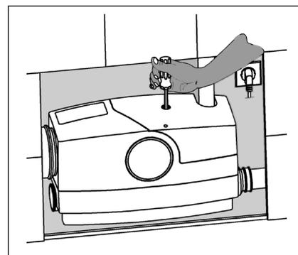
2. Loopt de pomp zwaar of is hij geblokkeerd, dan kan hij zonder verdere demontage opnieuw in gang worden gezet met een schroevendraaier. Daartoe de stop in het gat in de afdekkap verwijderen. Een lange schroevendraaier (Torx of inbus H5 30) door het gat in de afdekkap steken. Door licht draaien de vorm in de motoras aftasten en de verstopping verwijderen door met kracht de as in beide richtingen te draaien.
