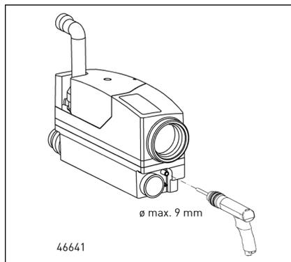
如需在紧急情况下排放箱内的水，应将一段水龙软管连接至右侧底部箱上。首先，您需要用螺旋钻（最大直径9mm）在管子上钻一个通孔，直径13 mm。将水龙软管压按到这个孔上，并用一个软管夹紧固好（拧紧扭矩：1.5 Nm）。确保水龙软管的出水口牢固密封。
