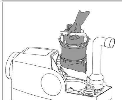
4. Retirer les corps étrangers présents dans le collecteur et sur la pompe via l'orifice d'aspiration et nettoyer les composants si nécessaire.
