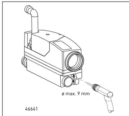
Vous pouvez monter un bout de tuyau de jardin à droite en bas du collecteur afin de prévoir une élimination des eaux usées accumulées en toute facilité en cas d'urgence. Pour ce faire, veuillez percer la tubulure Ø 13 placée sous le collecteur à l'aide d'un foret hélicoïdal (max. Ø 9). Pousser le tuyau et le fixer à l'aide d'un collier de serrage (couple de serrage 1,5 Nm). Veillez à ce que l'ouverture d'évacuation du tuyau soit bien fermée.
