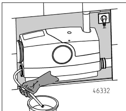
Jeśli podczas montażu założony został wąż na zbiorniku, wtedy można dokonać łatwego odprowadzenia spiętrzonej resztki wody. W tym celu, resztką wody zostaje spuszczone wężem do płaskiego naczynia. Następnie, wąż należy ponownie zaślepić odpowiednim korkiem.
