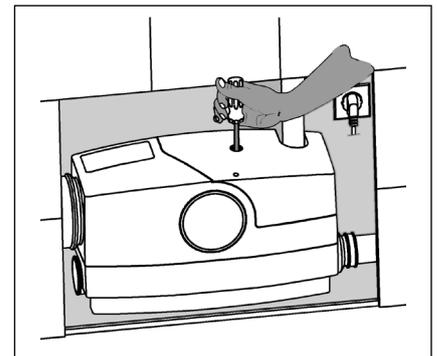
2. Ist die Pumpe schwergängig oder blockiert, kann sie mit einem Schraubendreher ohne weitere Demontage wieder in Gang gesetzt werden. Dazu den Stopfen der Bohrung in der Abdeckhaube entfernen. Einen längeren Schraubendreher (Torx 30 oder Inbus H5) durch die Bohrung in der Abdeckhaube stecken. Durch leichte Drehung den Sitz in der Motorwelle ertasten und die Blockierung durch kräftiges Drehen der Welle in beide Richtungen beseitigen.
