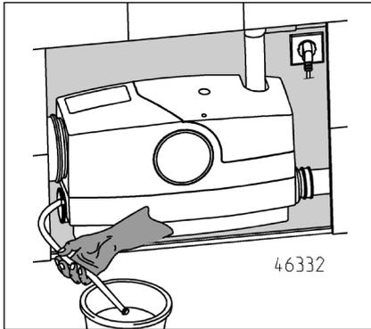
Se in fase di montaggio è stato montato un tubo flessibile nel serbatoio, è possibile svolgere uno smaltimento d'emergenza facile dell'acqua residua accumulata. A tal fine scaricare l'acqua residua tramite il flessibile in un recipiente piatto. Successivamente richiudere il flessibile con un tappo adeguato.
