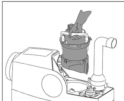
4. Fremdkörper aus dem Behälter oder der Pumpe durch den Saugmund entfernen und, falls erforderlich, Bauteile reinigen.
