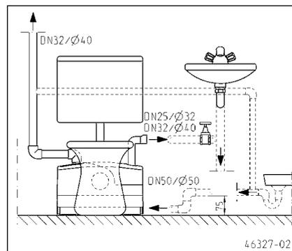
**ACHTUNG!** Ein Verbindungsrohr zwischen WCFIX und Toilette führt zu Betriebsstörungen. Dieser Einbauzustand entspricht nicht der Zulassung des Deutschen Instituts für Bautechnik.
