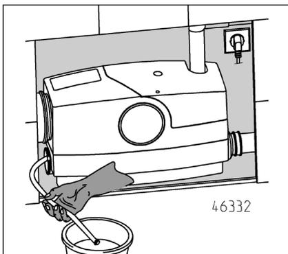
Ist bei der Montage ein Schlauch am Behälter montiert worden, kann eine einfache Notentsorgung des angestauten Restwassers erfolgen. Dazu wird das Restwasser über den Schlauch in ein flaches Gefäß abgelassen. Anschließend wird der Schlauch wieder mit einem geeigneten Stopfen verschlossen.
