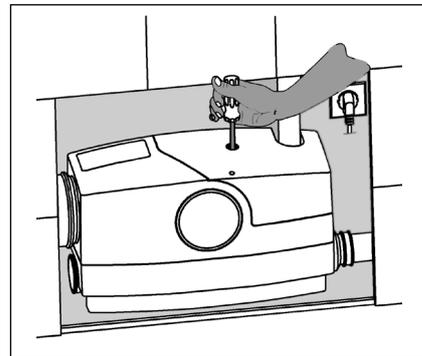
2. Si la pompe fonctionne mal ou si elle est bloquée, il est possible de la remettre en marche à l'aide d'un tournevis sans qu'un démontage ne soit nécessaire. Pour ce faire, retirer le bouchon de l'orifice sur le capot. Enfoncer un tournevis assez long (Torx 30 ou tournevis pour vis Allen H5) à travers
