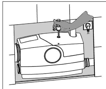
2. Jeśli pompa obraca się ciężko lub jest zablokowana, wtedy można ją uruchomić śrubokrętem bez konieczności demontażu. W tym celu należy wyjąć korek z otworu pokrywy. Wetknąć długi śrubokręt (grot 30 lub imbus H5) przez otwór w pokrywie. Przez lekkie obracanie wyczuć gniazdo w wałku silnika i usunąć blokadę poprzez siłę obracanie wałkiem w oba kierunki.
