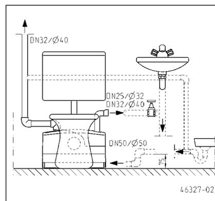
**ATTENTION !** Un tuyau de raccordement entre le WCFIX et les toilettes entraîne des dysfonctionnements. Un tel montage ne correspond pas à l'homologation de l'institut allemand des techniques du bâtiment.
