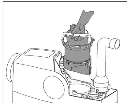
4. Rimuovere i corpi estranei dal serbatoio o dalla pompa tramite la bocca di aspirazione e, se necessario, pulire i componenti.
