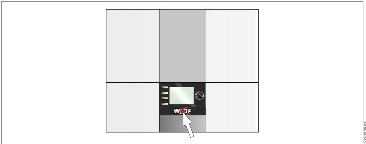
1. Wärmepumpe am Betriebsschalter ausschalten.
