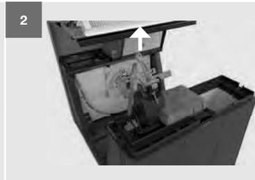
Lösen Sie die Anschlussfuge von der Modulierenden Bypass-Klappe.
