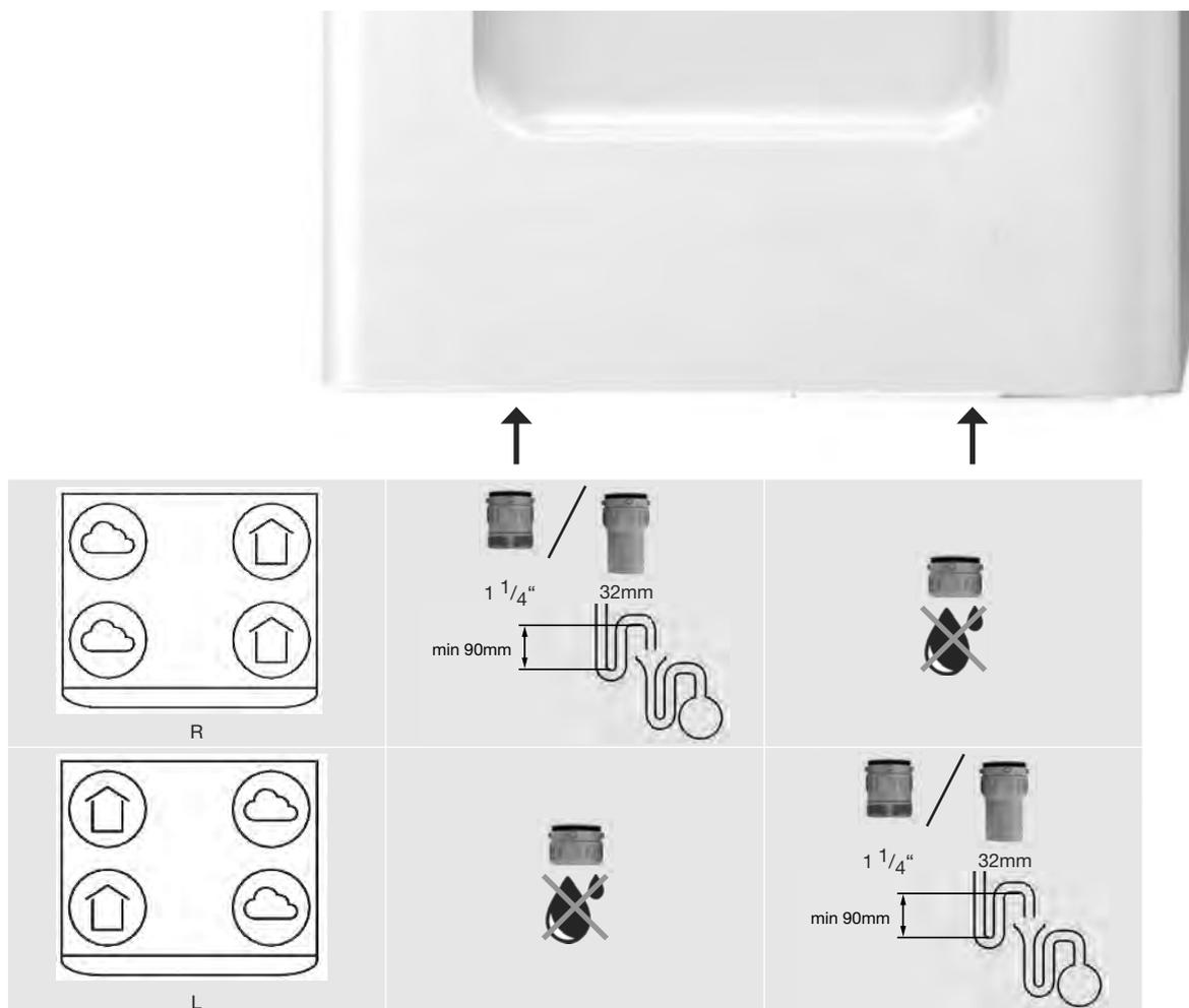
Das im Gerät entstehende Kondensat muss frostfrei mittels einem Gefälle abgeleitet werden und einen Luftabschluss (Siphon) ausweisen.
