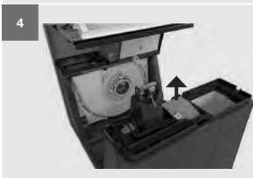
Entfernen Sie die Ventilatoranschlüsse aus der Sensorabdeckung. Entfernen Sie die Sensorabdeckung, indem Sie die Schnappverbindung öffnen.
