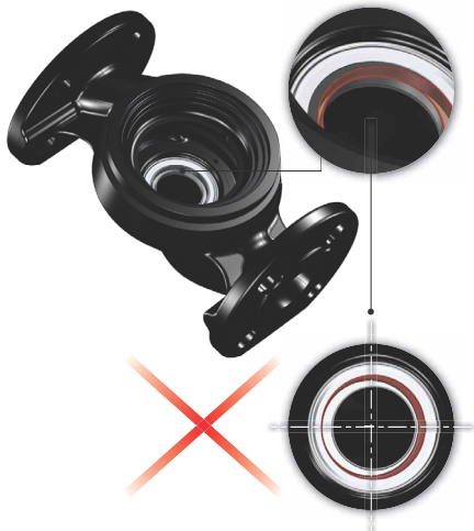
Abb. 17 Falsch zentriertes Abdichtungssystem
