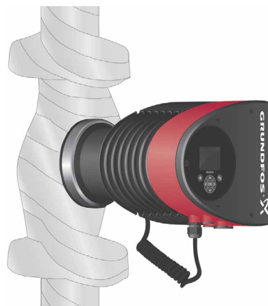
Abb. 19 Dämmen des Pumpengehäuses und der Rohrleitungen
