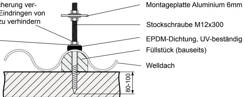
**Achtung** Es müssen alle gelieferten Stockschraben gleichmäßig auf der Kollektorfeldbreite verteilt werden, um die auftretenden Lasten zu verteilen.
