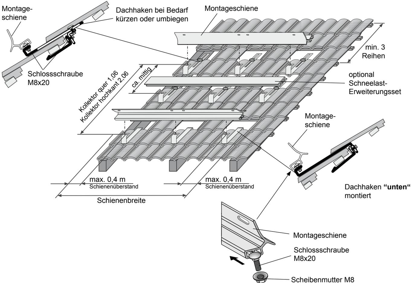
**Achtung** Es müssen alle gelieferten Dachhaken gleichmäßig auf der Kollektorfeldbreite verteilt werden, um die auftretenden Lasten zu verteilen. Die Dachhaken möglichst nahe an den Sparren positionieren.
