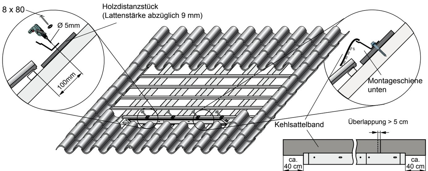
1. Mit  $\varnothing$  5mm vorbohren und Montageschiene mittels beiliegender Schlüsselschrauben 8x80 zusammen mit Holzdistanzstücken (Dachlattenstärke abzüglich 9 mm) am Sparren befestigen.
