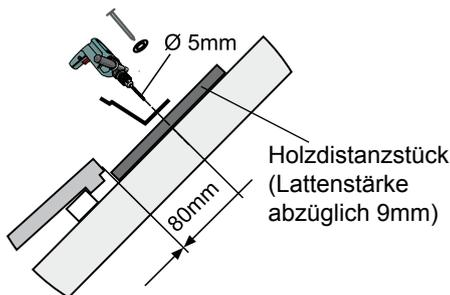
2. Mit Ø 5mm vorbohren und Montageschiene mittels beiliegender Schlüsselschrauben 8x80 zusammen mit Holzdistanzstücken (Dachlattenstärke abzüglich 9mm) am Sparren befestigen.
