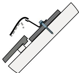
3. Kehlsattelband gem. Bild aufkleben, dabei Schutzfolie nur im Klebebereich für die Montageschiene abziehen. Das Kehlsattelband muss links und rechts ca. 30 cm über die Kehlsattelbandauflagen ragen. Mehrere Kehlsattelbänder müssen mit einer Überlappung von mindesten 5 cm miteinander verklebt werden. (Kehlsattelband noch nicht an Dachpfannen kleben, da die Kollektoren noch mit der Montageschiene verschraubt werden müssen!)
