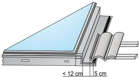
1. Montageschiene nach Montage der Verlängerung so ausmitteln, dass zwischen Kollektorfeld und fertiger Eindeckung auf beiden Seiten ein Spalt von kleiner 12 cm entsteht. Ist dies nicht möglich, müssen halbe Pfannen verwendet werden bzw. Pfannen geschnitten werden. Das Maß < 12 cm muss gewährleistet sein, um eine regendichte Eindeckung zu erreichen.
