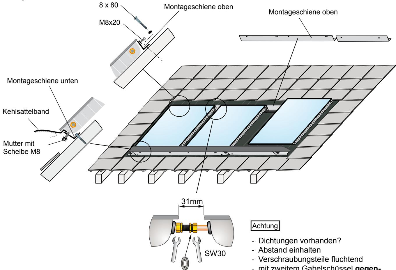
1. Kollektor mit den Gewindestiften zuerst in die untere Montageschiene einsetzen und durch Mutter mit Scheibe M8 vorerst nur handfest sichern.
