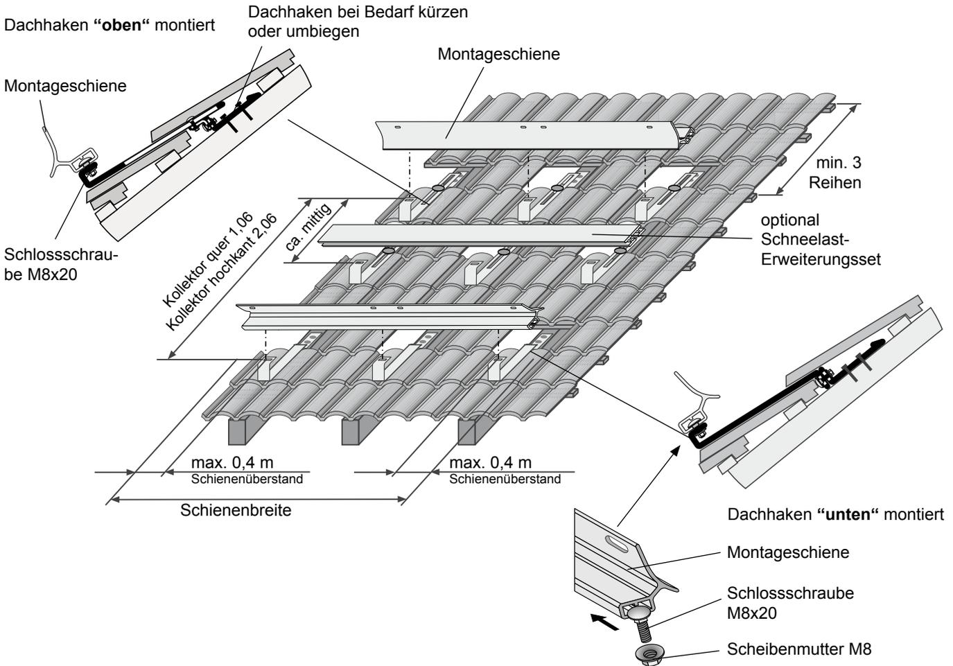
**Achtung** Es müssen alle gelieferten Dachhaken gleichmäßig auf der Kollektorfeldbreite verteilt werden, um die auftretenden Lasten zu verteilen.
