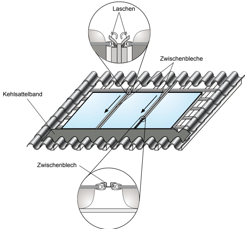
1. Zwischenbleche von oben einschieben. Sollten diese bei der Montage klemmen, Position der Kollektoren korrigieren. Anschließend die Laschen oben an den Zwischenblechen umbiegen, um ein Durchrutschen zu verhindern.
