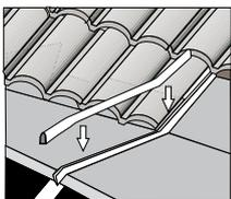
3. Kantenschutzprofile an den Verbindungsstellen der Verkleidungsbleche oben über die Aufkantungen gem. Bild stecken.
