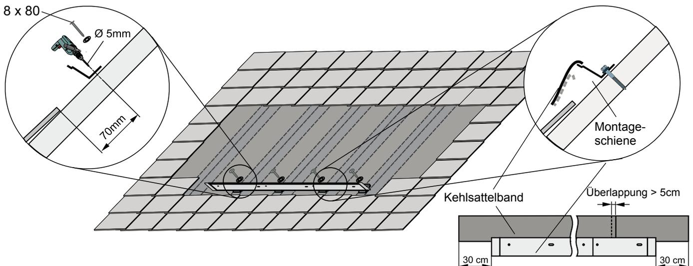
1. Mit  $\varnothing 5\text{mm}$  vorbohren und Montageschiene mittels beiliegender Schlüsselschrauben 8x80 am Sparren befestigen.
