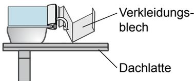
1. Verkleidungsbleche links und rechts gem. Bild einhängen und mit Haften befestigen.
