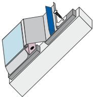
2. Verblechung oben an Kollektorrahmen aufstecken. Zur Auflage am Sparren muss an jedem Sparren ein Holzdistanzstück mit Höhe Lattung unter dem Verkleidungsblech montiert werden. Verkleidungsblech mit Haften befestigen.
