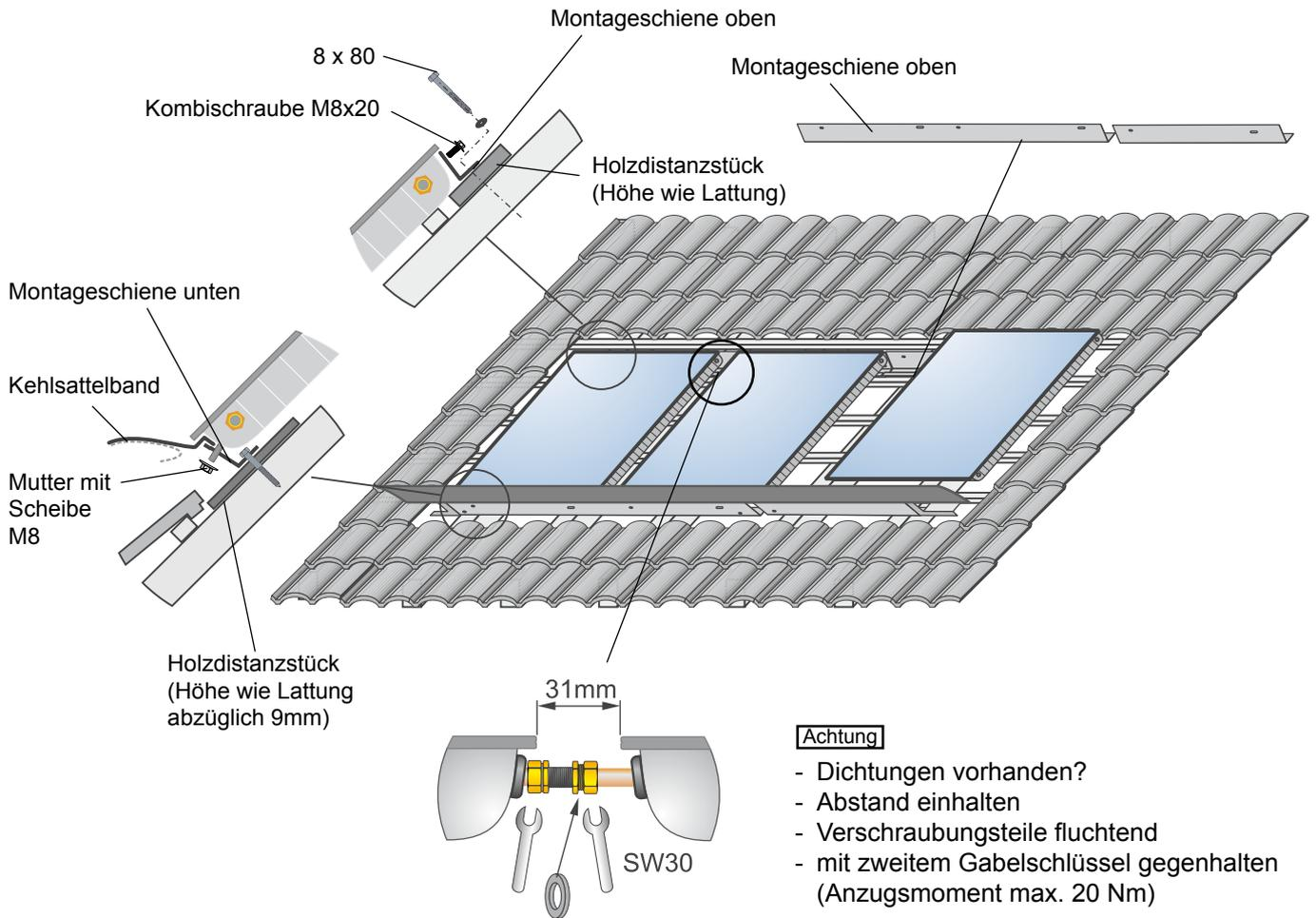
1. Kollektor mit den Gewindestiften zuerst in die untere Montageschiene einsetzen und durch Mutter mit Scheibe M8 vorerst nur handfest sichern.
