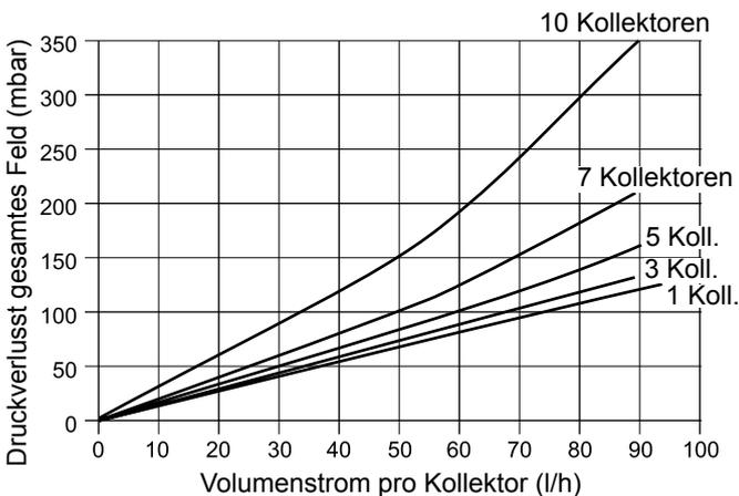
Druckverlust F3-1 mit ANRO 30°C
