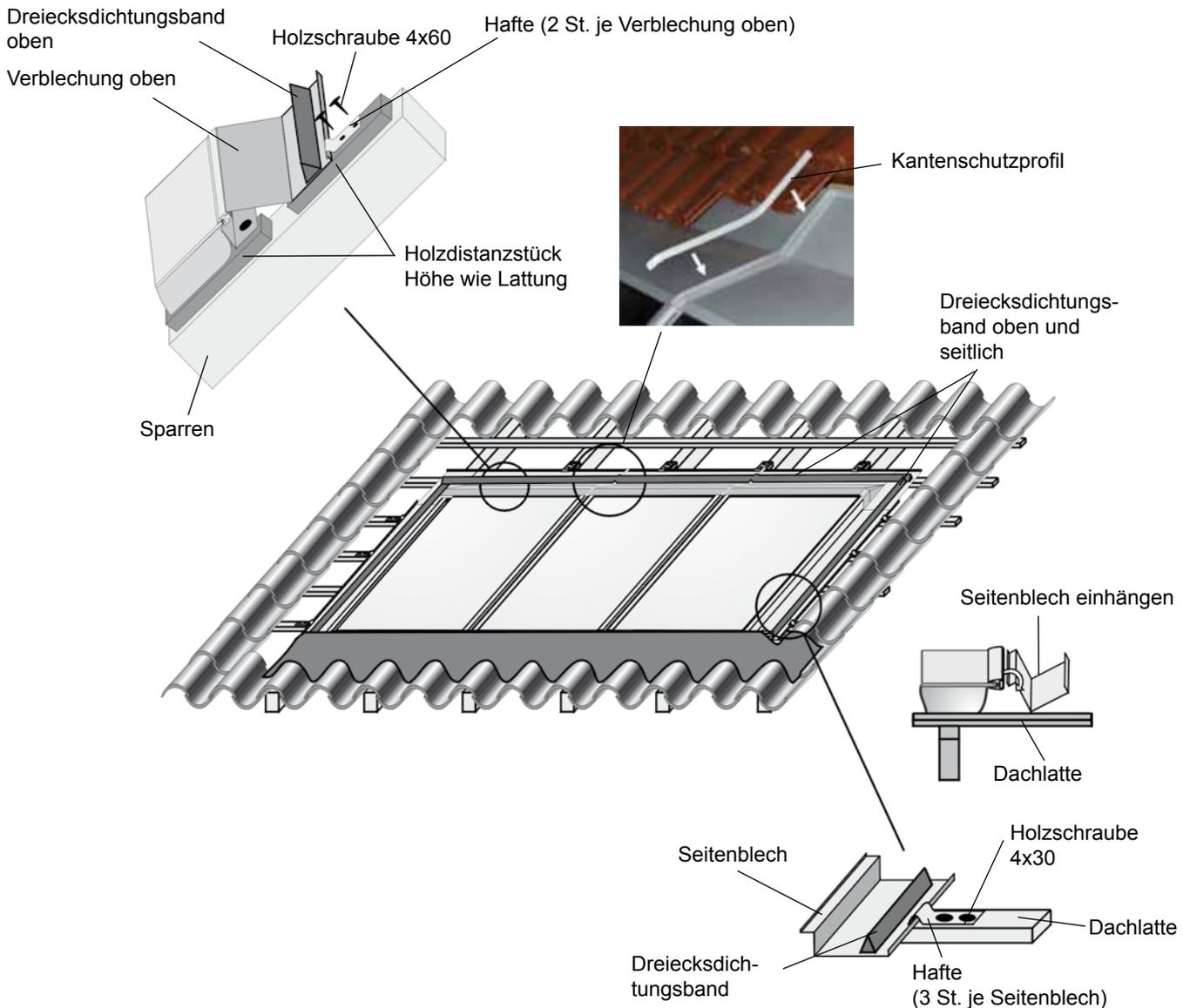
Verkleidungsbleche links und rechts gemäß Bild einhängen und mit Haften befestigen.
