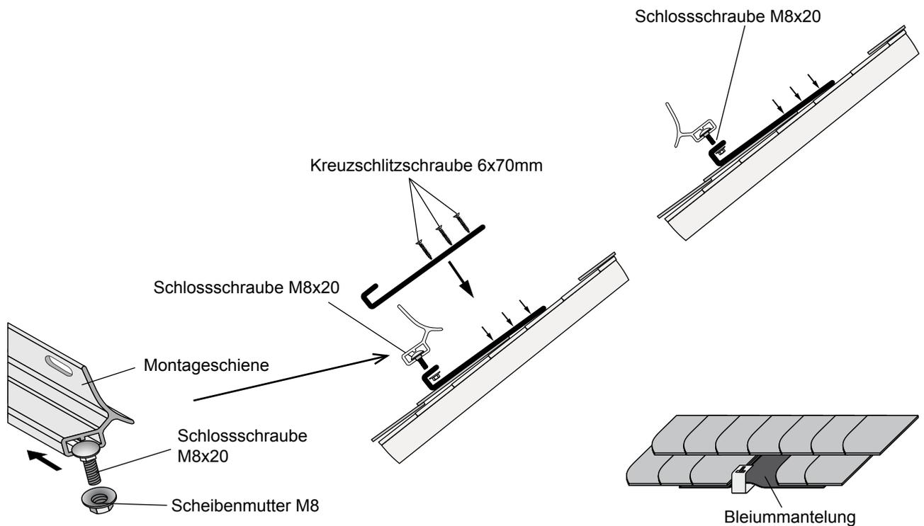
**Achtung** Es müssen alle gelieferten Dachhaken gleichmäßig auf der Kollektorfeldbreite verteilt werden, um die auftretenden Lasten zu verteilen.
