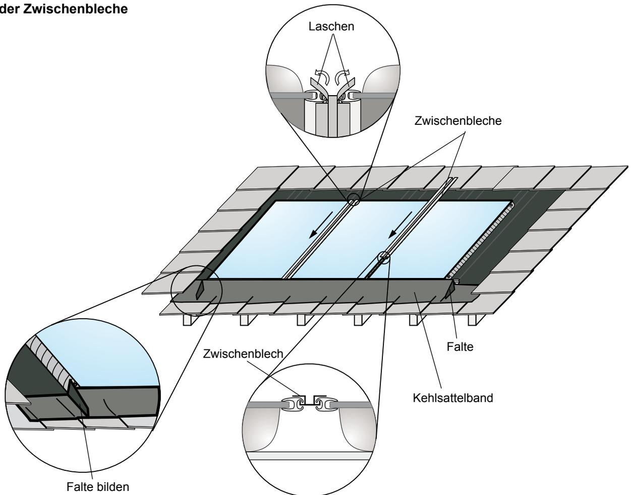
1. Zwischenbleche von oben einschieben. Sollten diese bei der Montage klemmen, Position der Kollektoren korrigieren. Anschließend die Laschen oben an den Zwischenblechen umbiegen, um ein Durchrutschen zu verhindern.
