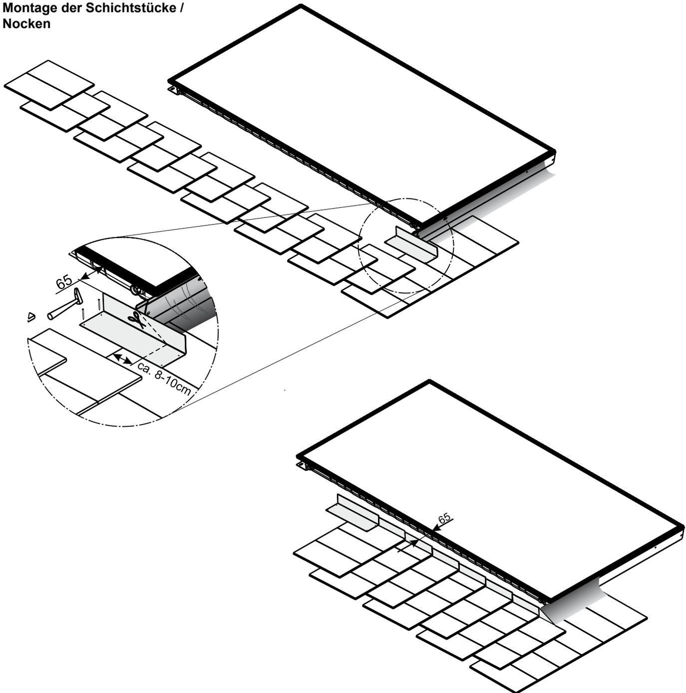
1. Unterste Nocke an die Kehlsattelband - Falte anpassen und ggf. mit Schere ablängen. Auf ausreichend Überdeckung (8-10 cm) achten.
