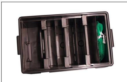
Rozciąć opakowanie granulatu z tworzywa sztucznego i rozdzielić cały granulat równomiernie na pięć pozostałych komór. Granulat powinien tworzyć w poszczególnych komorach płaską powierzchnię, a przegródki komór muszą być widoczne (nieprzysypane)!
