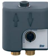
Die neue Verschnideeinheit beim LEX Plus 10 Connect macht das Einstellen der gewünschten Härte denkbar einfach: Verschnideventil ein Stück herausziehen, drehen, bis im Display des LEX Plus 10 Connect die gewünschte Härte angezeigt wird, Ventil wieder herunterdrücken – fertig. **Langwieriges Messen überflüssig.**
