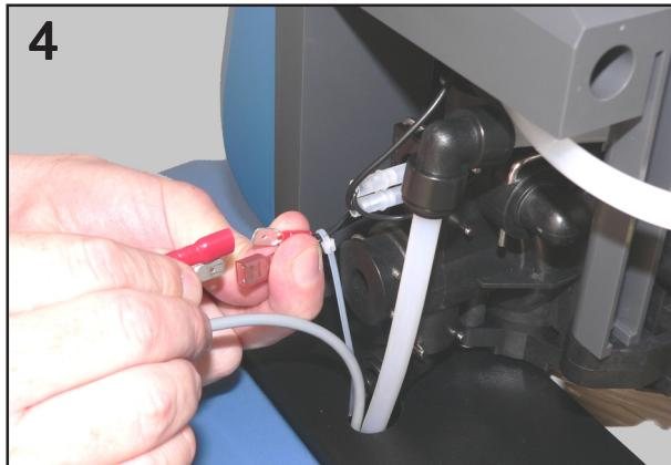
Das Anschlusskabel mit den Steckern am Steuerventil verbinden.
