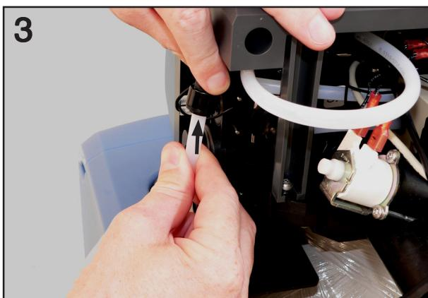
Soleschlauch bis zum Anschlag (ca 15 mm tief) in den Schlauchwinkel einstecken.
