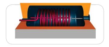
Anwendung: Unterstellbrauchwasserspeicher für Öl, Gas Feststoffe und dergleichen
