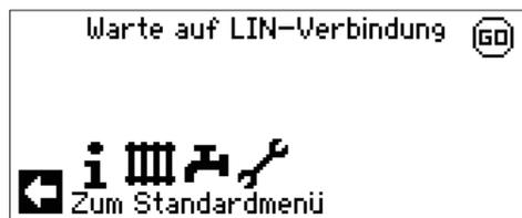
Nach Erlöschen dieser Anzeige kann das Gerät ordnungsgemäß betrieben werden. Ansonsten 3-polige Leitung für die BUS-Verbindung prüfen.
