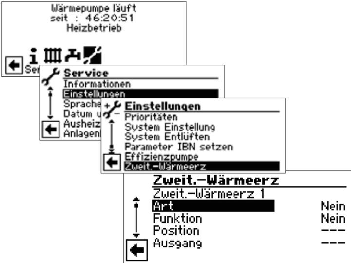
Hier können Sie angeschlossene Zusatzwärmeerzeuger aktivieren und deren Parameter einstellen oder angeschlossene Zusatzwärmeerzeuger deaktivieren
