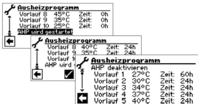
Nach dem Start des Ausheizprogramms werden die programmierten Vorlauf-Temperaturstufen automatisch nacheinander abgefahren.
